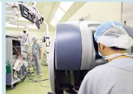
da Vinci Sは、高精細な3Dハイビジョンカメラの映像を見ながら操作できるのが特長。視野の広さや明るさ、拡大能力に優れ、精緻な動きをするアームによってきめ細かな作業が可能
