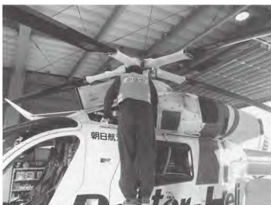
Figure 2 "UNDER INSPECTION" printed on the vest 整備士は整備中に「点検中」を表記したベストを着用、作業に専念できる環境を確保した
