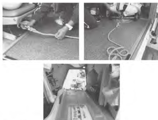
Figure 3 A rope to support the stretcher ヘリとストレッチャーをロープで結び、キャスターがロックされるまで不用意にストレッチャーを引き出せないようにした
