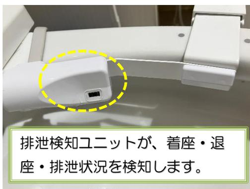
排泄検知ユニットが、着座・退座・排泄状況を検知します。
