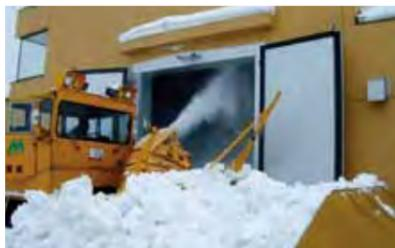
● 貯雪庫への雪の搬入は2月。半日で約300トンの雪を入れ込む。「雪が完全に解けた9〜10月頃に、貯雪庫内の清掃をします。それが雪冷房に必要な唯一のメンテナンスです」
