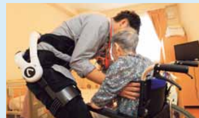
腰に装着し、移乗介助などの動作をサポートする介護ロボットは、職員の身体にかかる負担を軽減。腰痛のリスクを減らし、安全に介助を行うことができます
