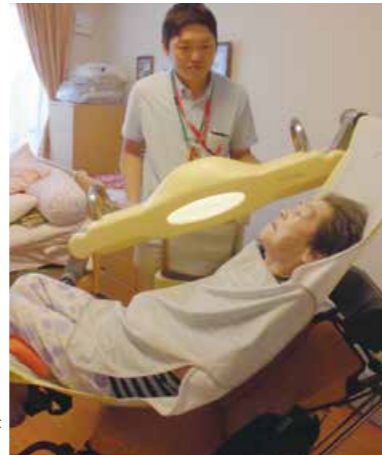
手稲つむぎの杜に導入した移乗用リフト型ロボット
